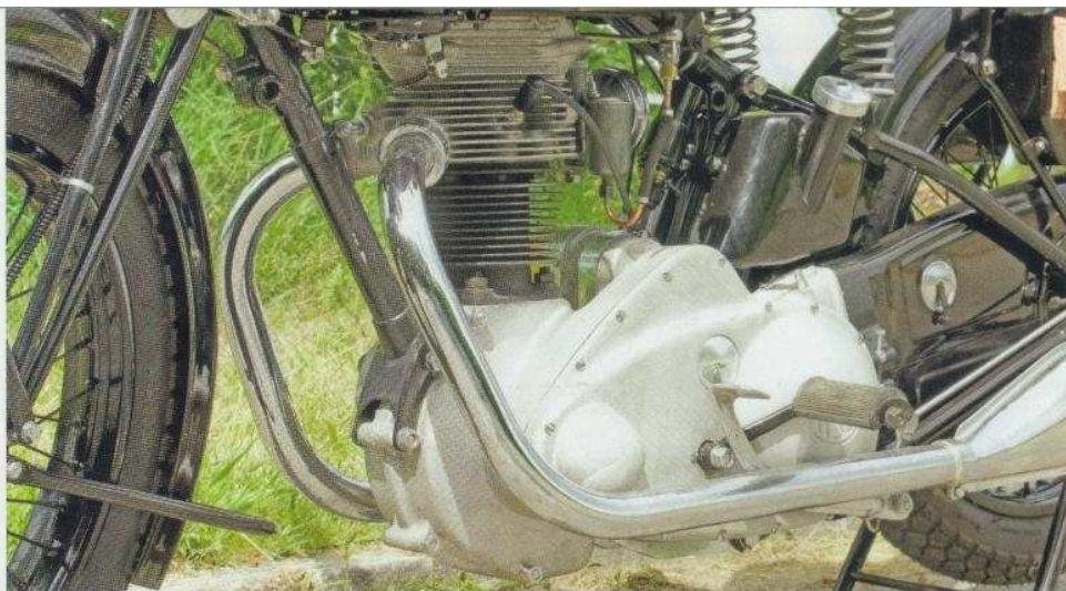
Otwarta rama nie zapewniała sztywności motocyklowi na szybko pokonywanych zakrętach
