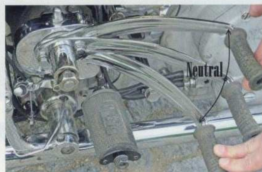
Ogromny skok dźwigni zmiany biegów i trudności ze znalezieniem „luzu” to poważna wada motocykla.
