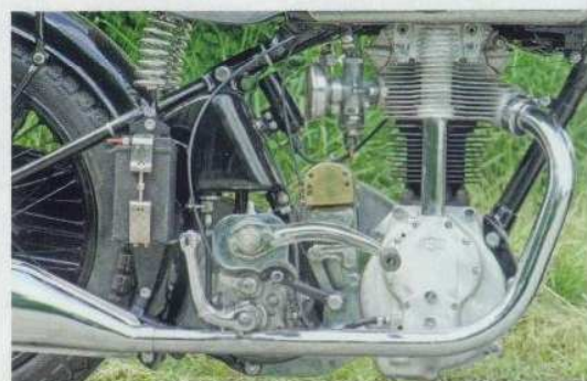
Sucha miska olejowa była tu koniecznością, a dobry układ olejenia jest jedną z zalet tego silnika.
