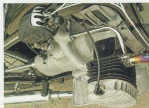
Podgrzewanie kolektora ssącego spalinami wcale nie było pomysłem na potrzeby wojskowe, ale bardzo się przydało w armii!
