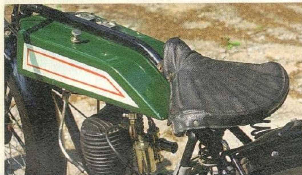
➤ Mechaniczna pompa oleju potrzebowała wspomaganie: ręcznej pompki używanej przy dużym wyężeniu silnika
