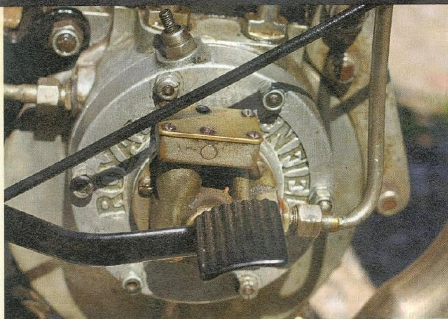
➤ Mechaniczna pompa oleju potrzebowała wspomaganie: ręcznej pompki używanej przy dużym wyężeniu silnika
